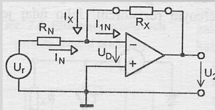
Toto zapojení se obvykle používá pro měření větších odporů (v případě měření napětí na výstupu OZ, neumožňuje toto zapojení čtyřsvorkové připojení měřeného rezistoru) a obvod je navržen tak, aby velikost referenčního i výstupního napětí byla stovky mV až jednotky V.
