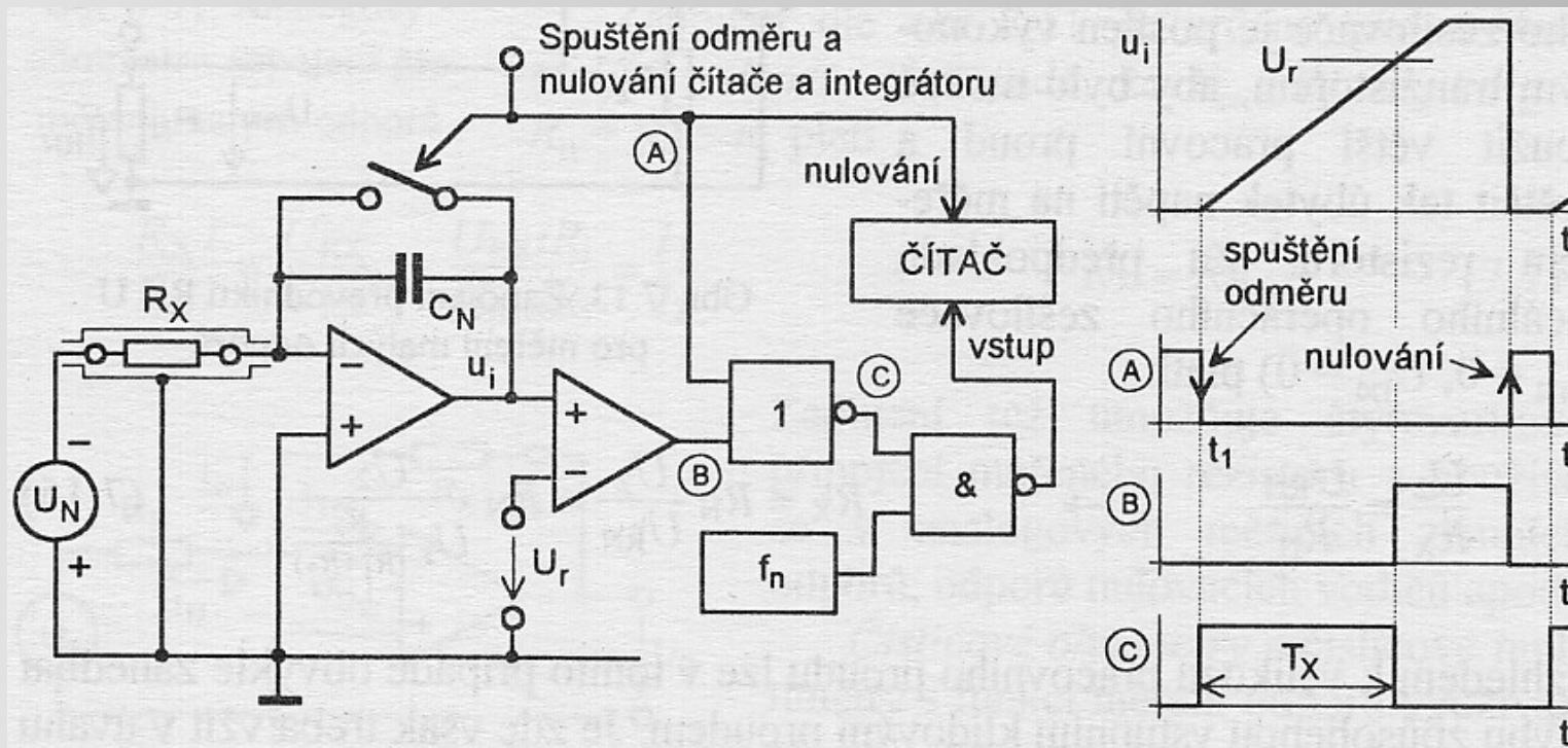
lineárně roste, ale pokud je menší než referenční napětí  $U_r$ , je výstup komparátoru B = 0, logický signál C = non(A+B) otevře hradlo a čítač čítá impulsy z generátoru. Když výstupní napětí integrátoru dosáhne hodnoty  $U_r$ , komparátor překlopí, signál C zavře hradlo a načtený počet impulsů je úměrný době  $T_x$ . Neznámí odpor  $R_x$  lze
